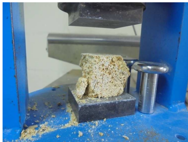
Rotura de la piedra arenisca.
