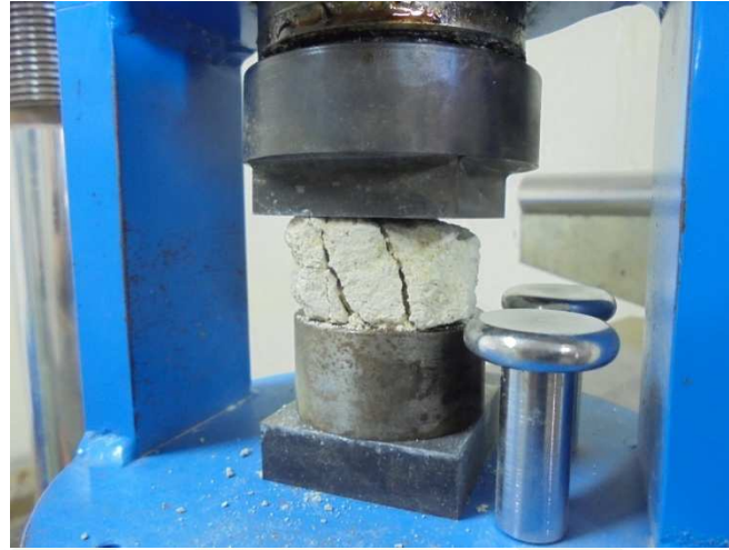
Rotura del mortero de cal.
