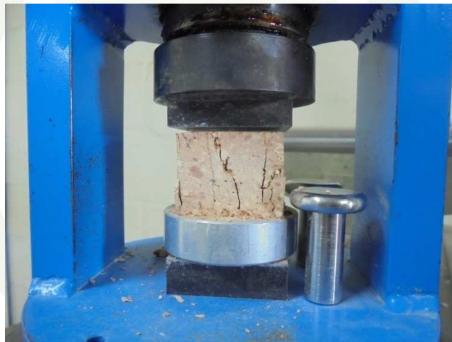
Rotura del ladrillo cerámico.
